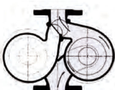
Дясната помпа работи
