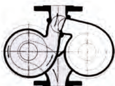
Лявата помпа работи
